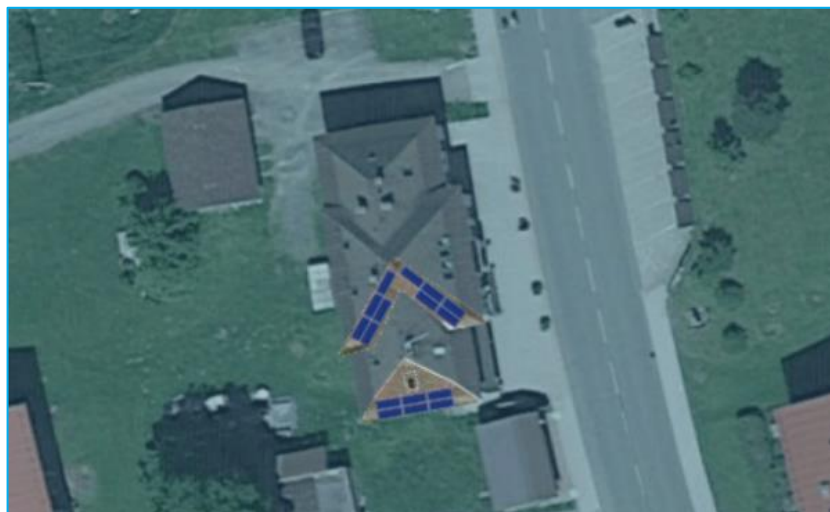
Obrázek 6 Umístění FVE na střeše obecního úřadu
